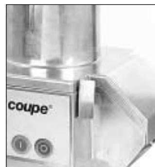
Приподнимите головку овошерезки, наклоняя ее назад, чтобы высвободить емкость.
